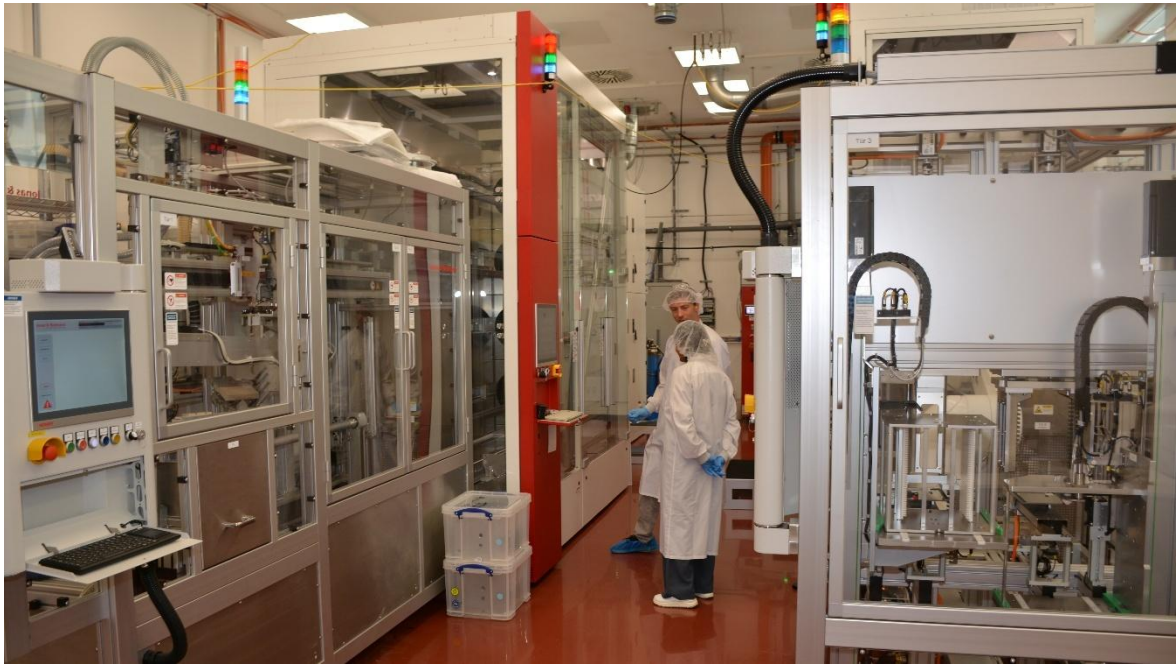
Forschung trifft Maschinenbau: Blick auf die neue Prozessanlage am ISC Konstanz mit automatisierter Beladeeinheit von Jonas & Redmann und Vier-Rohr-Diffusionsofen von centrotherm. Solche industrienahen Forschungsinfrastrukturen ermöglichen es, neue c-Si-Prozesse unter produktionsnahen Bedingungen zu entwickeln und zu erproben. Foto: ISC Konstanz
