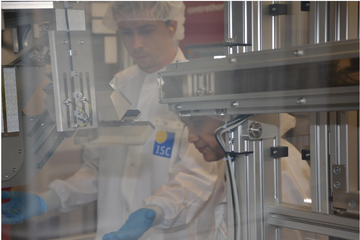
Experimentelle Prozessentwicklung am ISC Konstanz: Dr. Jan Hoß (links) und Apoorva Gattu besprechen ein Experiment an der Beladeeinheit des Diffusionsofens. Hier werden Prozesse für kristalline Silizium-Solarzellen unter industrienahen Bedingungen entwickelt und erprobt.
